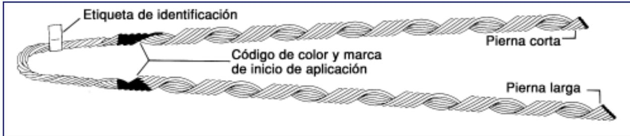
Las Retenciones **Big-Grip - BG** utilizadas para el arriostamiento de torres de líneas de transmisión de energía eléctrica, antenas, torres de telecomunicaciones y otros tipos de estructuras arriostadas con cables de gran diámetro presentan:
