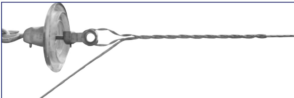
La Retención Preformada - DG se destina al anclaje de cables conductores de aluminio, sujetos a esfuerzos de tracción sin torsión. Se aplica sobre el cable con las manos, sin el uso de ninguna herramienta, adhiriendo sin dañar la camada protectora por el hecho de no ejercer ninguna concentración de esfuerzos sobre el cable, ni aún en la condición máxima de tracción.
