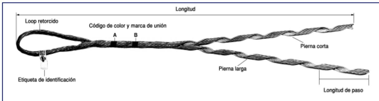
La Retención Preformada para Cables de Acero - **GDE** y **AWDE** se destinan al anclaje de cables de acero galvanizados y cables de acero revestidos de aluminio, respectivamente, sujetos a esfuerzos de tracción sin torsión.
