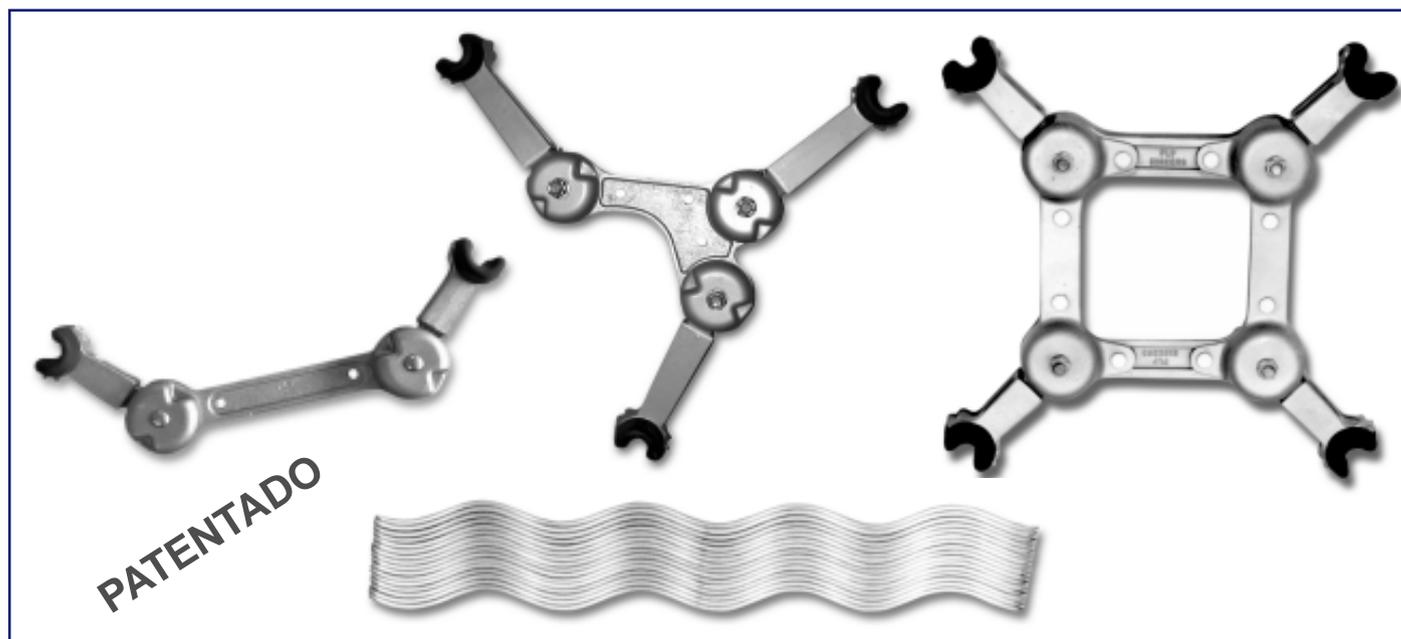
El Espaciador Amortiguador Preformado - AGSD, utilizado para mantener la separación y estabilidad del haz de subconductores, evitar las oscilaciones del subvano y atenuar las vibraciones de los conductores en las líneas de transmisión, además de mantener la eculización eléctrica de los subconductores, presenta:
