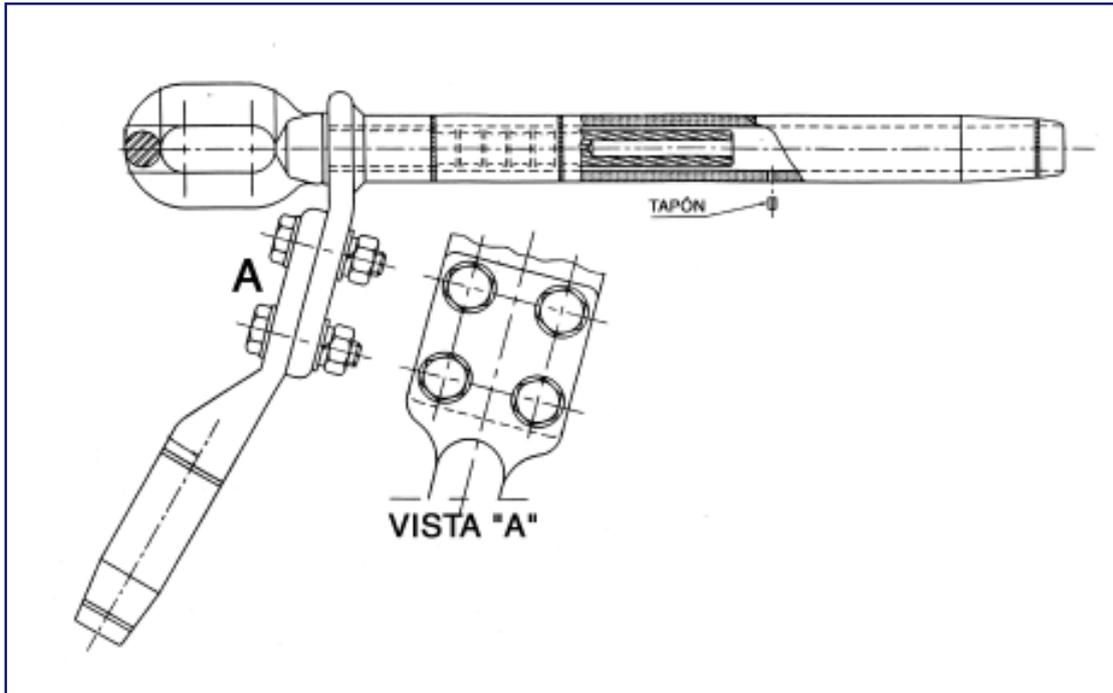
La Grapa de Retención a Compresión destinada a la fijación de conductores en las cadenas o cables de guardia utilizados en los soportes de fin de línea, retención intermedia y de ángulo presenta:
